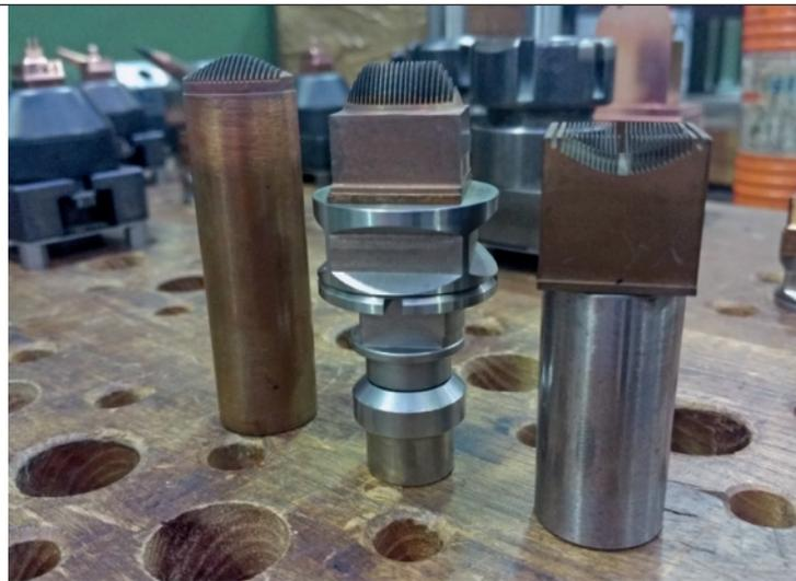
Elettrodi generati con erosione a filo avente diametro pari a 0,1 mm.
