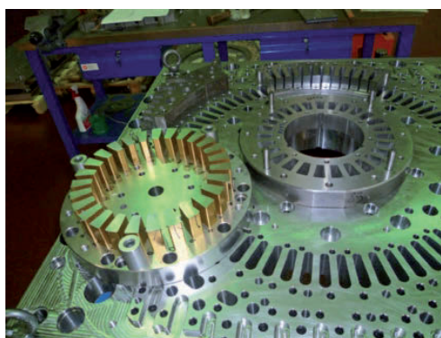
Figg. 5 e 6 - Lo stampo, pur essendo di grosse dimensioni, deve garantire giochi di tranciatura dell'ordine di pochi centesimi.
