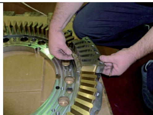
Figg. 5 e 6 - Lo stampo, pur essendo di grosse dimensioni, deve garantire giochi di tranciatura dell'ordine di pochi centesimi.
