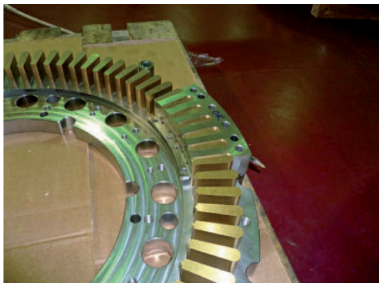
Fig. 4 - La superficie gialla di tranciatura è una conseguenza del trattamento TiN.
