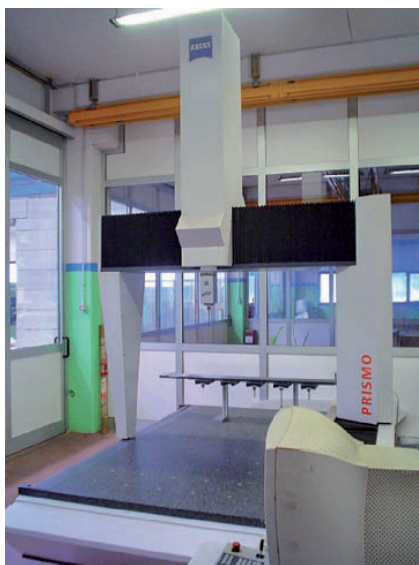
Fig. 9 - Su una macchina di misura Zeiss sono state controllate le dimensioni.
